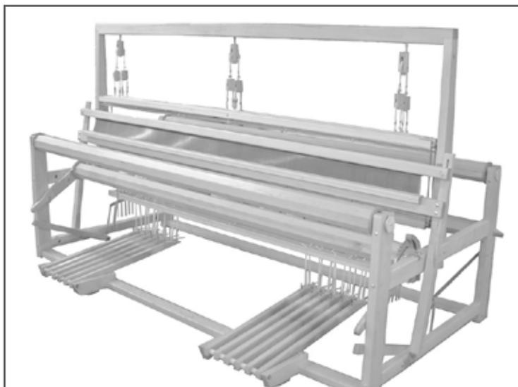
Un métier 4 cadres, contre-balancé, pour le tissage large tel que couvertures, draperies, tapis, etc. Élargi à 49" (125 cm) de profond, il donne une ouverture parfaite. Il est le métier le plus souple de cette largeur sur le marché. Il doit être opéré par deux tisserands, chacun ayant son pédalier, permettant de lancer et de recevoir la navette à tour de rôle. Le système de frein est très solide avec 2 gros câbles d'acier
