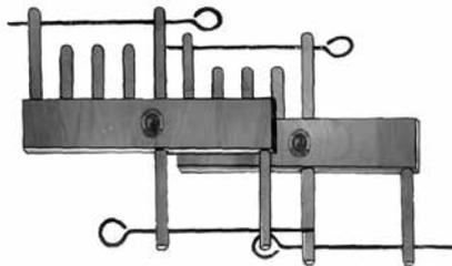
Sert à la fois de stabilisateur de cadres et de support pour les baguettes d'encroix, gardant ainsi la croisée à la hauteur pratique pendant le passage en lames.
