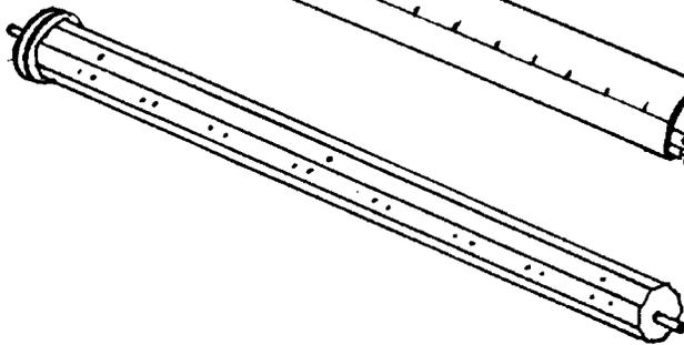
1 WARP BEAM WITH BRAKE DRUM
