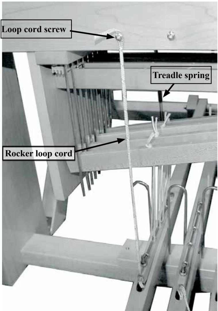
**VIEW FROM THE BACK OF THE LOOM SHOWING THE TREADLE AT REST POSITION AND DEPRESSED.**
